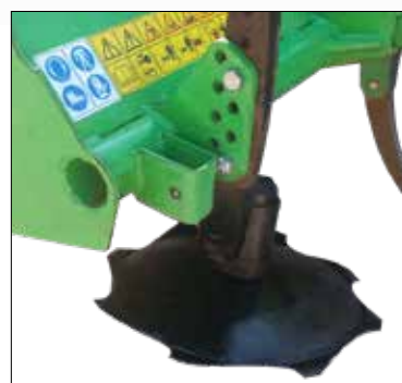
Rotoslitte di regolazione profondità. Rotating device adjustment. Disques pour le réglage de la profondeur. Ajuste de profundidad giratorio. Drehtiefenverstellung.
