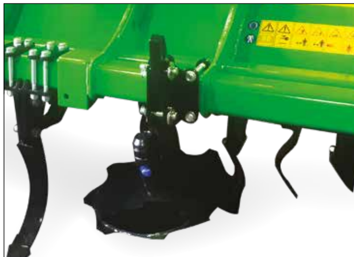
Rotoslitte di regolazione profondità Rotating device adjustment Disques pour le réglage de la profondeur Ajuste de profundidad giratorio Drehtiefenverstellung
