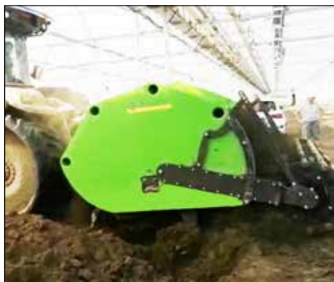
BIGROTAR portato (in serra) con sistema di rientro automatico del rullo livellatore a gabbia
