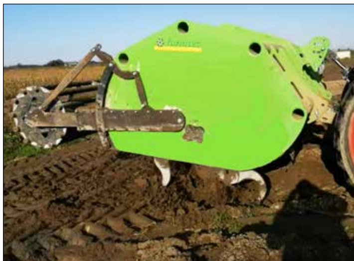
BIGROTAR portato (in campo aperto) con sistema di rientro automatico del rullo a gabbia
