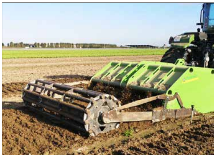
BIGROTAR amené (en champ libre) avec système de rentrée automatique du rouleau cage
