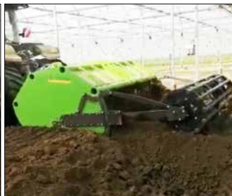
BIGROTAR traído (en un invernadero) con un sistema de retorno automático de rodillo nivelador de jaula
